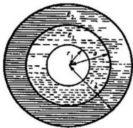
Fig. 90 Condensador esférico o cilíndrico de dos capas
