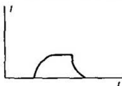
Fig. 190 Forma de los impulsos de corriente para los impulsos rectangulares de tensión
